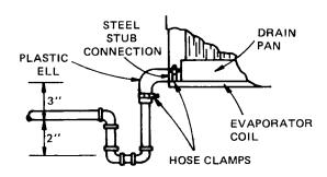
FIGURE 14 - RECOMMENDED DRAIN PIPING REFRIGERANT MAINS
